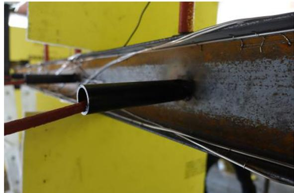
(d) Instrumentation for horizontal displacement measurement
